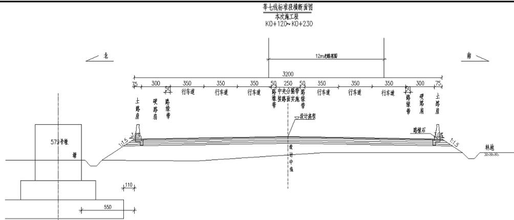
图 2-2 莘七线标准断面图
