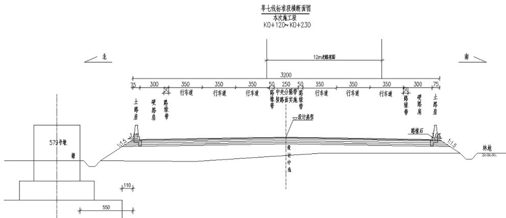
图 2.1-1 莘七线标准断面图
