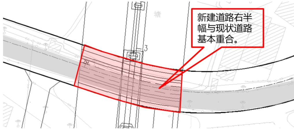
图 2-5 莘七线平面示意图
