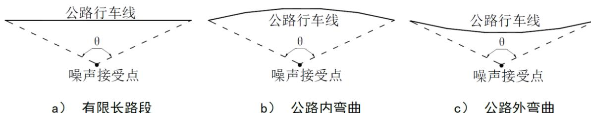
图 5.2-1 预测点到有限长路段两端的张角
