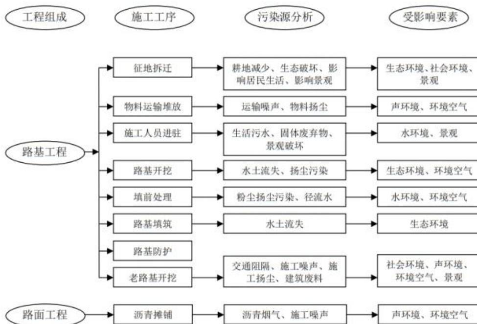
图 4-1 施工工艺及产污节点图
