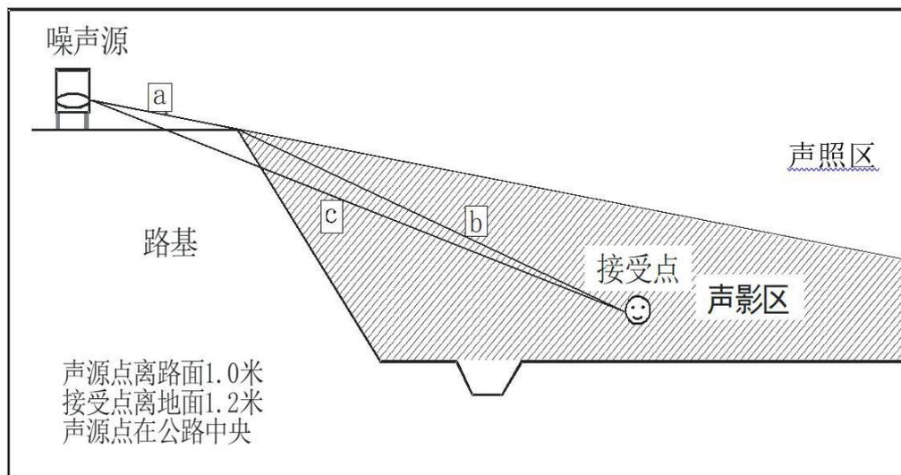
图 5.2-4 声程差  $\delta$  计算示意图
