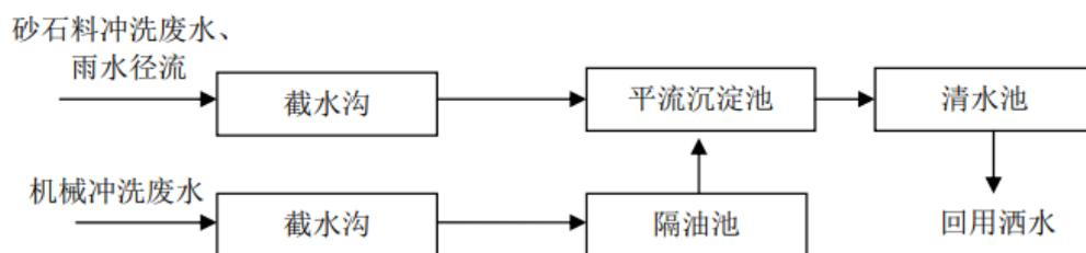
图 5-1 施工废水处理工艺图
